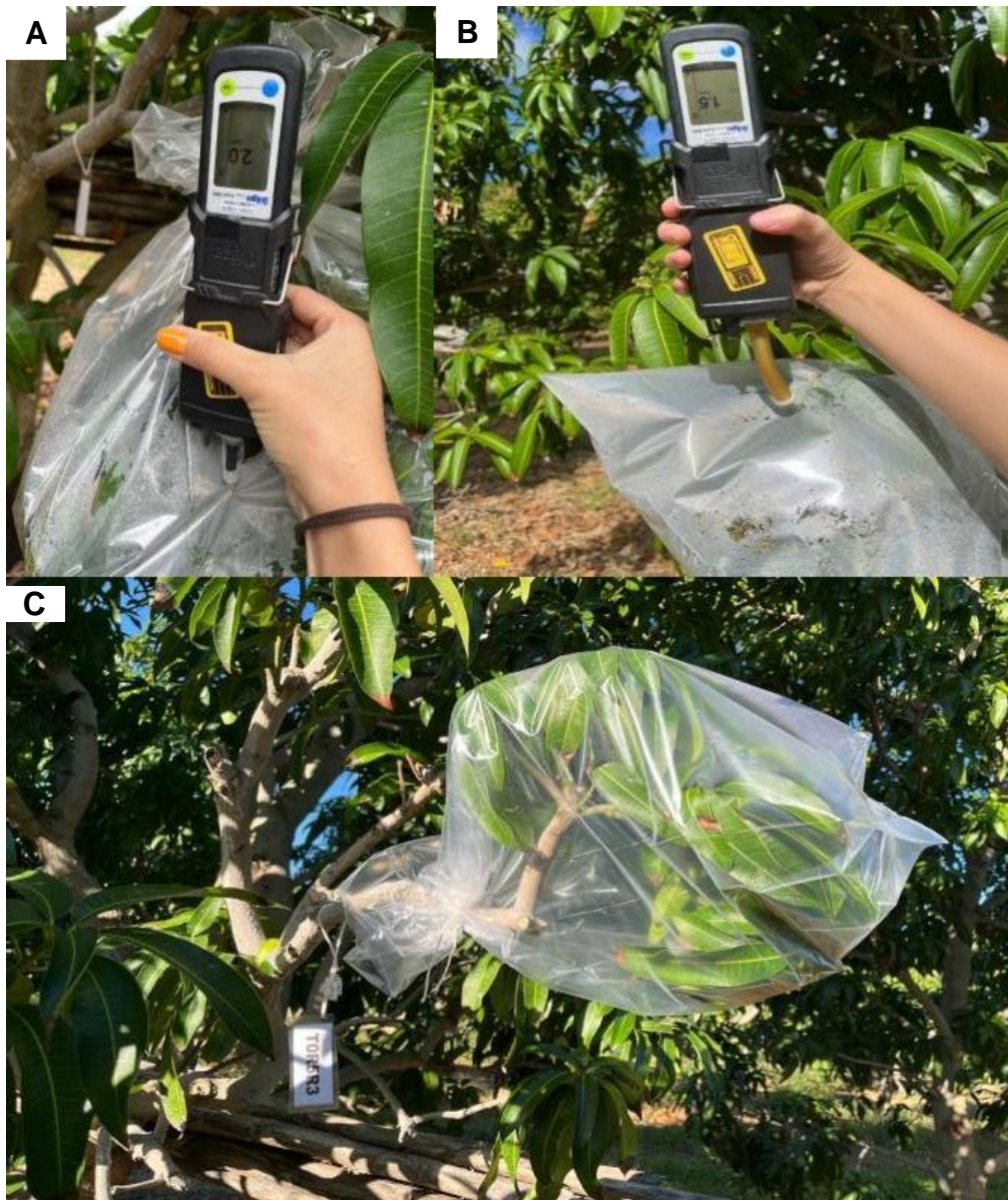
Figura 4. Aparelho detector de gases Dräger X-am em (A) e (B) e ramo com saco plástico vedado com barbante em ramos de mangaueira cv. 'Kent'. Petrolina-PE, 2023.
