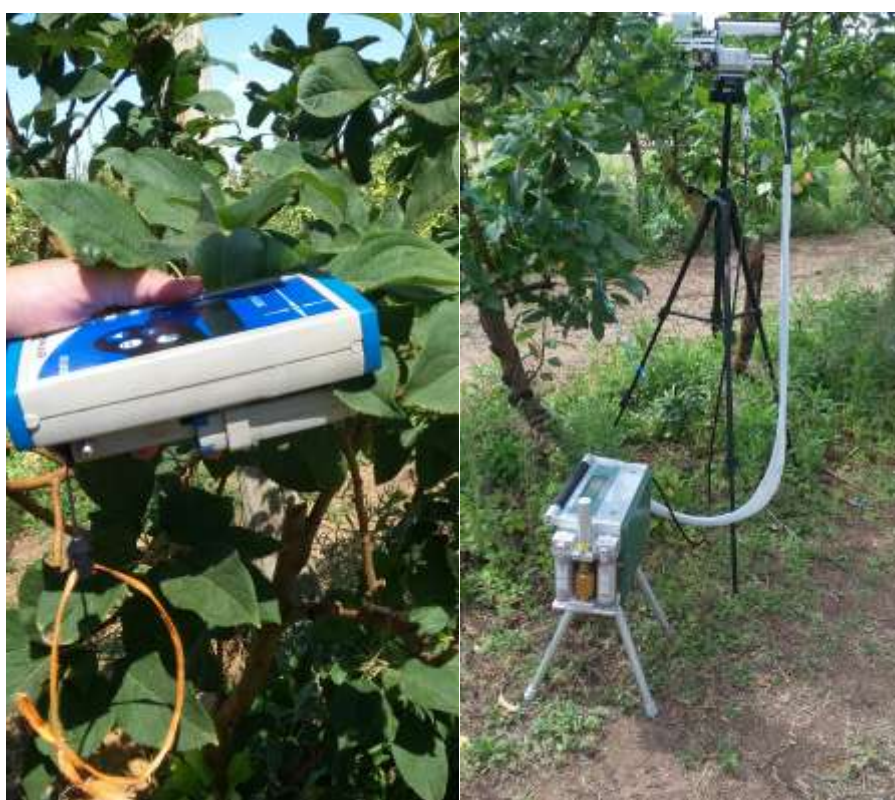
Figura 3. Medidor Eletrônico de Clorofila (esquerda) e analisador de gás Infra-Red Gas Analyser (IRGA) modelo Licor 6400. Fonte: Próprio autor.
