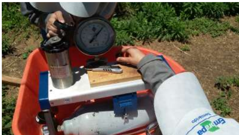
Figura 4. Avaliação de potencial hídrico de macieiras com câmara de Scholander. Fonte: Próprio autor.
