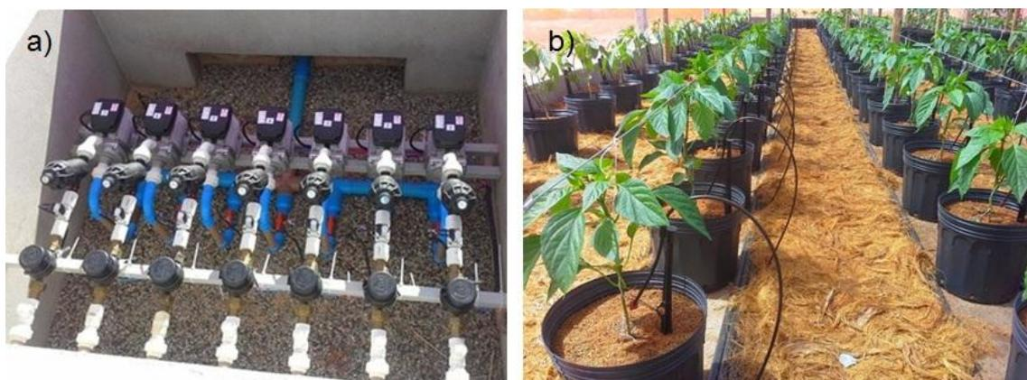
Para a determinação da uniformidade de distribuição de água do sistema, foi realizado um ensaio de vazão em todos os gotejadores utilizados no experimento. A partir dos dados de vazão foi possível determinar a uniformidade de emissão dos emissores utilizados em cada tratamento (Eq. 1 e Tabela 2).
