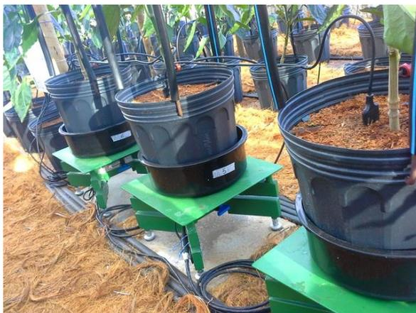
Todos os lisímetros de pesagem foram calibrados com o auxílio de uma balança de precisão obtendo-se as equações de regressão apresentadas na Tabela 3. Os parâmetros das equações lineares obtidos foram embarcados ao circuito eletrônico por ocasião da configuração do sistema de automação.
